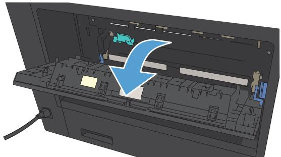
2. 向下按绿色卡舌以打开热凝器卡纸检查盖。
