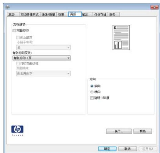
4. 选中双面打印复选框。单击确定按钮以关闭文档属性对话框。
