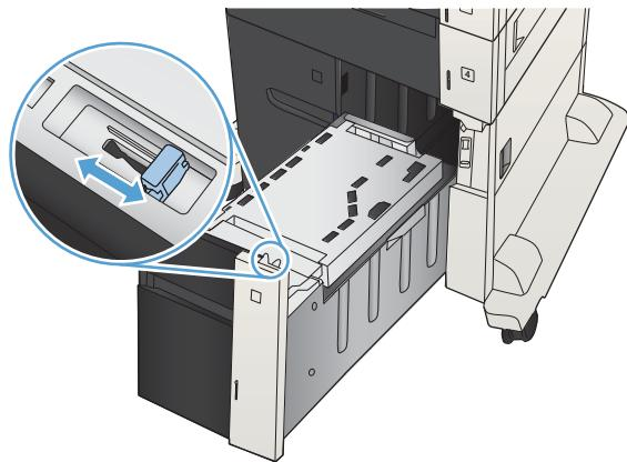
3. 将整令纸装入纸盘的每一侧。右侧可容纳 1,500 张纸。左侧可容纳 2,000 张纸。
